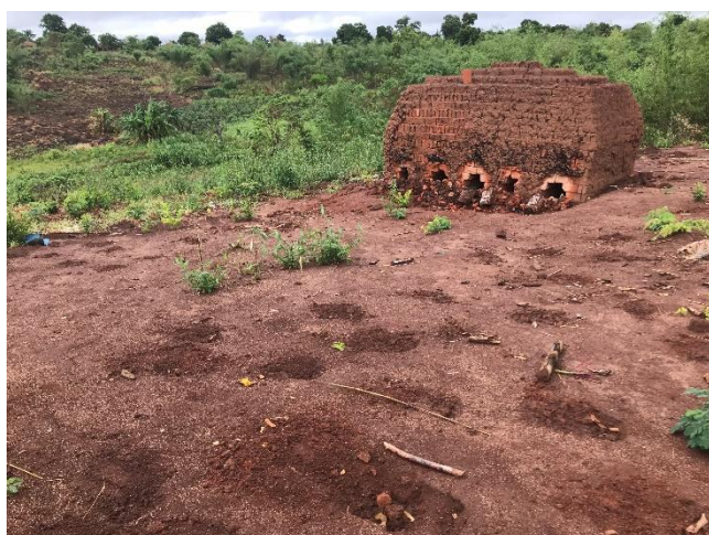
Figura 18 – Forno local de produção de blocos (resiliente) – Namedoe, 2021
